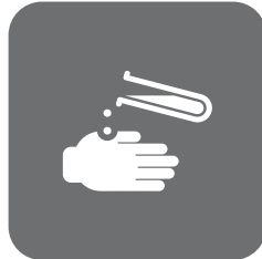
PRODUTOS CORROSIVOS CORROSIVE PRODUCTS
